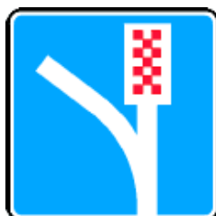
6.5 Полоса для аварийной остановки
